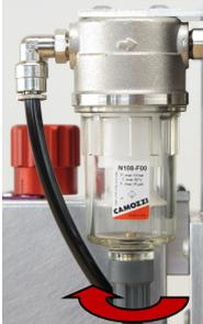
Der Kondensatabscheider befindet sich unter dem Rückdeckel neben dem Verdampfer.
